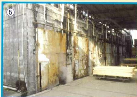
⑤ 人工乾燥 10日間 含水率8~10%に調整
